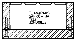
SP.168 (160*80) EI30 PALOSUOJATTU SÄHKÖJOHTOELEMENTTI ELEMENTISSÄ 125 * 60 TILAVARAUS SÄHKÖ- JA TELEJOHDOLLE PALOERISTYS EI30 PALONSUOJAKIPSILEVY KNAUF DB15 POHJAOSASSA NIPPUSIDELENKIT KAAPELEIDEN KIINNITYSTÄ VARTEN
