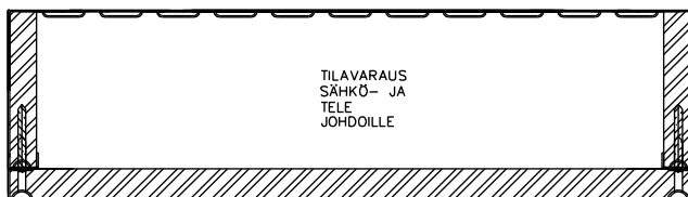
SP.4312 (430*120) EI30 PALOSUOJATTU SÄHKÖJOHTOELEMENTTI ELEMENTISSÄ 395 * 100 TILAVARAUS SÄHKÖ- JA TELEJOHDOLLE PALOERISTYS EI30 PALONSUOJAKIPSILEVY KNAUF DB15 POHJAOSASSA NIPPUSIDELENKIT KAAPELEIDEN KIINNITYSTÄ VARTEN
