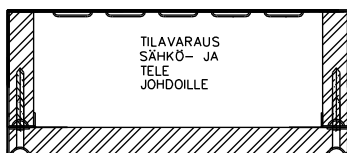
SP.2310 (233*100) EI30 PALOSUOJATTU SÄHKÖJOHTOELEMENTTI ELEMENTISSÄ 200 * 80 TILAVARAUS SÄHKÖ- JA TELEJOHDOLLE PALOERISTYS EI30 PALONSUOJAKIPSILEVY KNAUF DB15 POHJAOSASSA NIPPUSIDELENKIT KAAPELEIDEN KIINNITYSTÄ VARTEN
