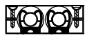
ELEMENTTITYYPPI KE.114 (110*40) PUTKIKOOT ENINT. KV18 LV18 ELEMENTTI EI SISÄLLÄ PUTKIERISTEITÄ EIKÄ -PITIMIÄ
